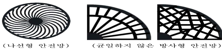
<그림 1> 비방사형에 해당하는 안전망 앞면 예시
